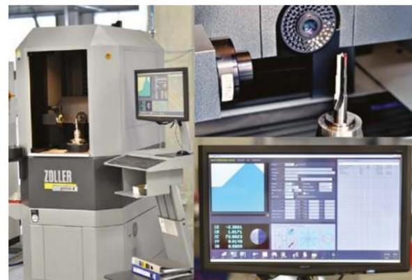
APPAREIL DE MESURE ZOLLER - GÉOMÉTRIE ET CONTRÔLE DES OUTILS D'USURE
